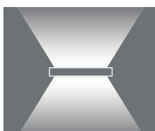
ATARO HYBRID: Optimal dosiertes Direktlicht nach unten (LED) und Indirektlicht nach oben (Leuchtstoff), dimmbar.
