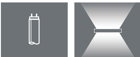
ATARO Leuchtstoff: optimale Dosierung von Direktlicht nach unten und Indirektlicht nach oben.
